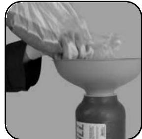
Trichter auf leere Patrone aufsetzen und neues Harz einfüllen.
