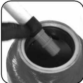
Filterdüse muss an Steigrohr vorhanden sein.
