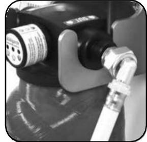
Anschlussverschraubung lösen. Patrone aushängen.
