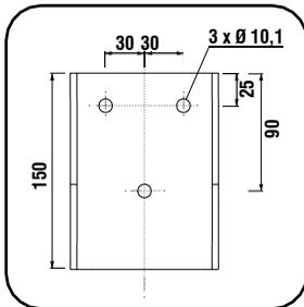
Wählen Sie für die Wandmontage der Edelstahl-Anschlussarmatur einen gut zugänglichen Ort aus. Das Mauerwerk, an welches das Wasserfiltersystem montiert werden soll, muss über ausreichend Festigkeit und Tragkraft von mindestens 20 kg verfügen. Wir raten davon ab, die Station an Wänden mit alten sandenden Putzen zu montieren.
